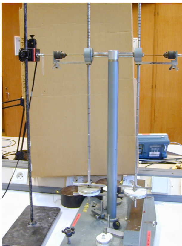
Figure 1: Photographie du dispositif expérimental pour étudier la variation de la période d'un pendule en fonction de l'amplitude des oscillations. On utilise le système de pendules couplés DIDALAB, dans lequel on découple les deux pendules. L'angle d'oscillation, ainsi que la vitesse angulaire, sont mesurés dans cet exemple au moyen du capteur de rotation PASCO.
