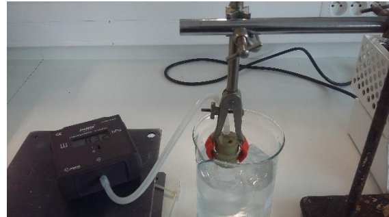
Thermomètre à gaz plongé dans le mélange eau + glace pilée
